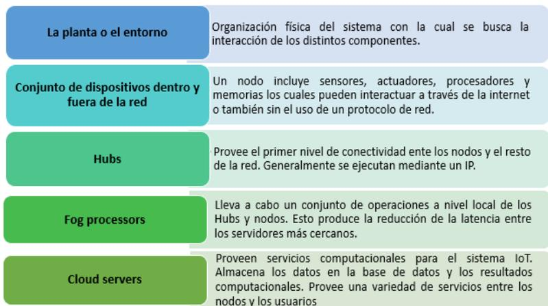
Figura 1. Componentes de un sistema IoT
